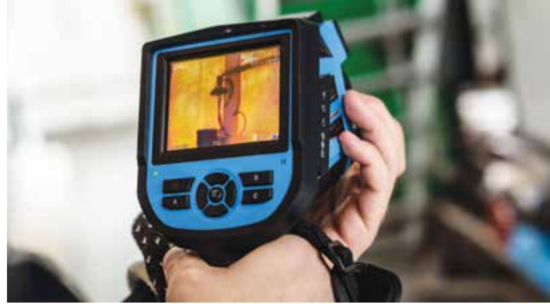
Überprüfung des Energieverbrauchs mit einem Thermographen
