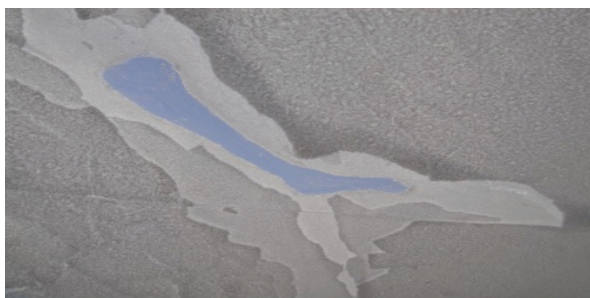
Зураг 80: Хүлэмжийн нийлэг хальсан бүрхүүлд конденсаци үүссэн байдал
