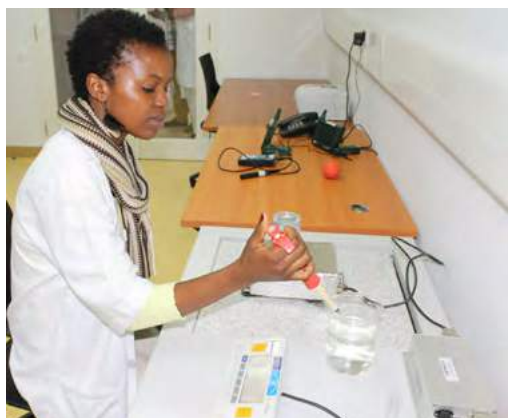
Calibração de volume em laboratório do INNOQ
