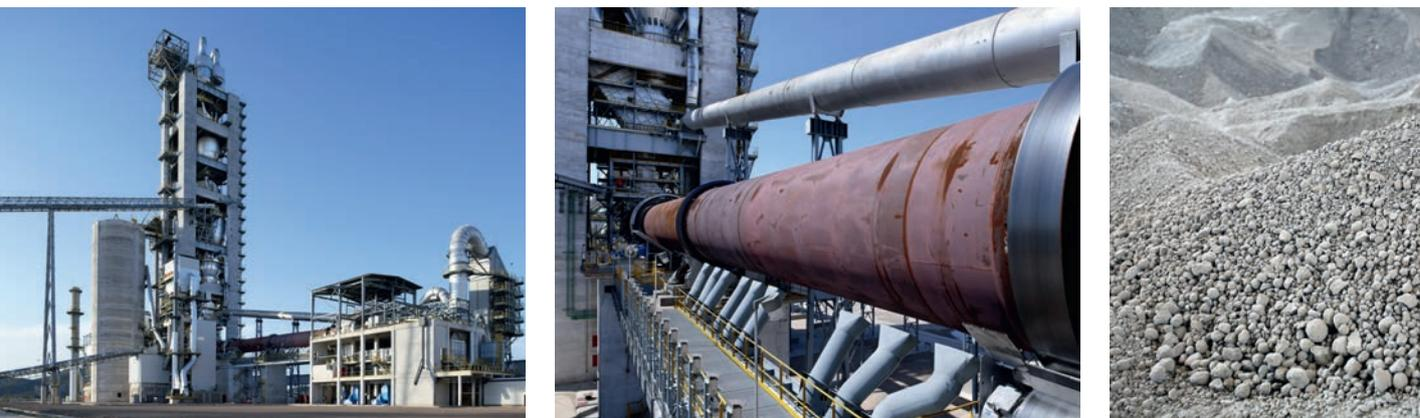
Цементный завод с функциями совместной переработки (слева), вращающаяся цементная печь (в центре) и производимый клинкер (справа).
